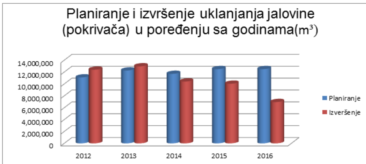
Figura 47. Upoređenje planiranja i realizacije uklanjanja pustoši u zadnjih pet godina
