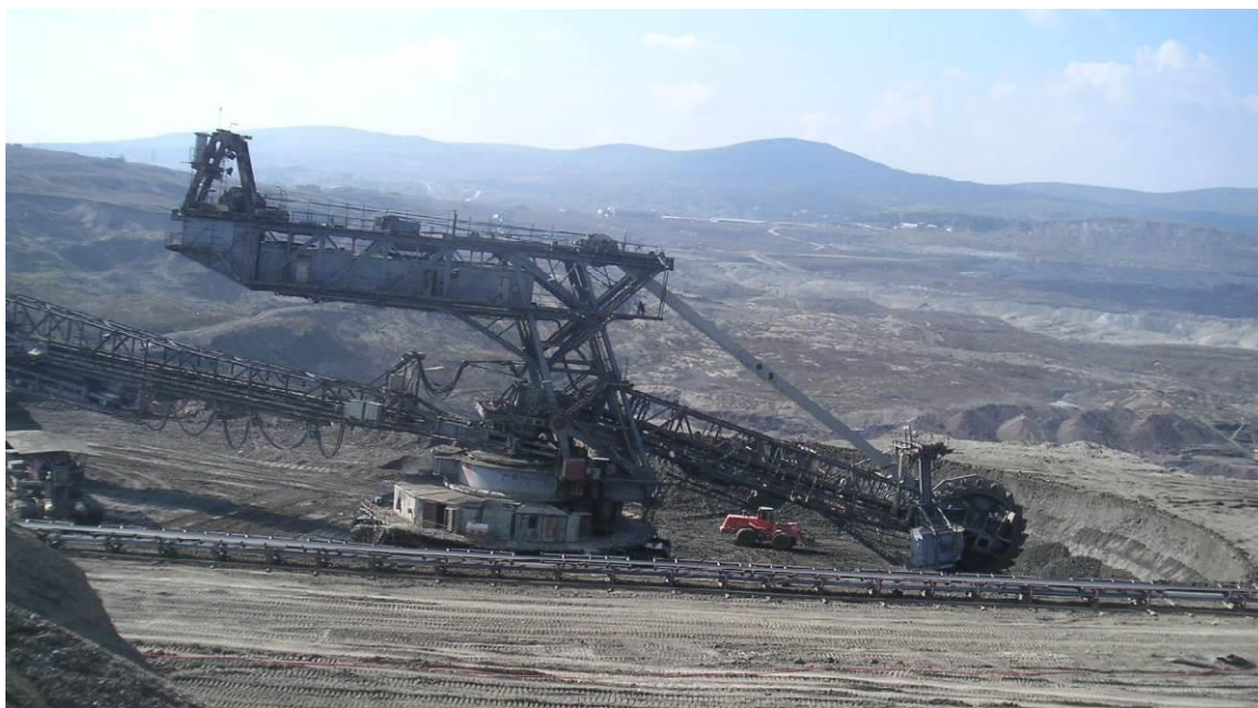
Figura 34. Rotorni eskavator tokom rada u rudniku EKK-a
