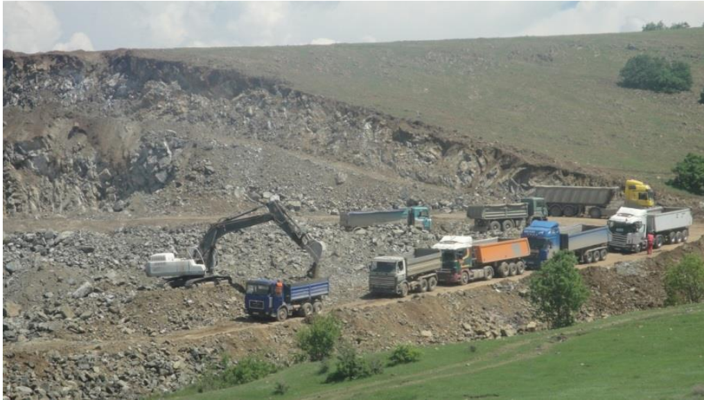
Figura 12 Largimi i mbulesës si fazë përgatitore e fillimit të punëve minerare- KPMM
