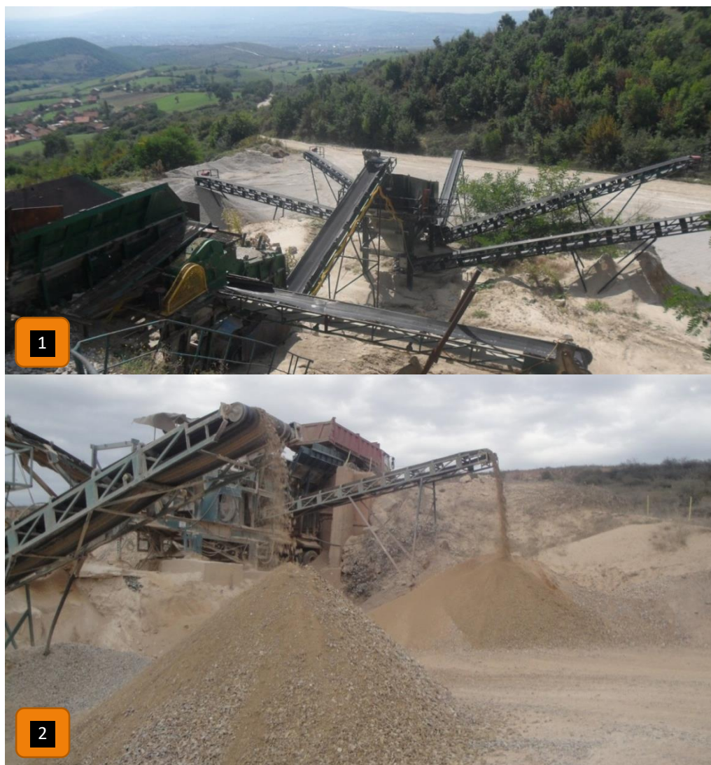
Figura 81 Sistemi efikas i punës se seperacioneve duke përdorur sistemin e spërkatjes apo sistemin ventilues - Insp. Komunal
