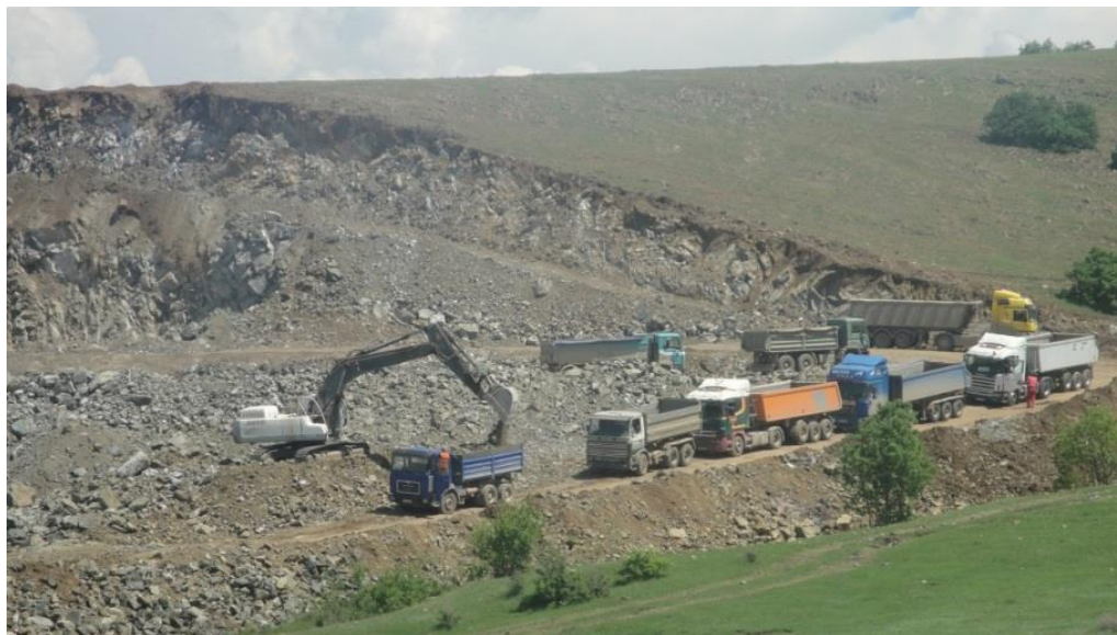
Figura 60 Largimi i mbulesës si fazë përgatitore e fillimit të punëve minerare
