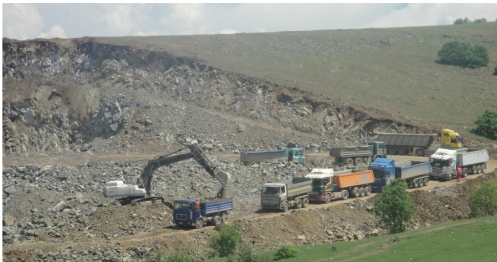
Figura 35 Largimi i mbulesës si fazë përgatitore e fillimit të punëve minerare - MMPH
