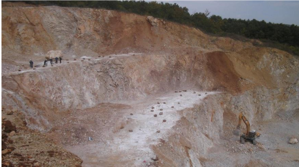
Figura 62 Priprema polja za rudarske aktivnosti za miniranje
