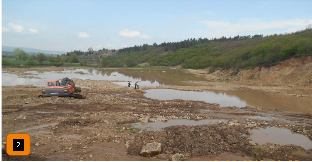
Figura 70 Iskorištavanje inercija u reci, oštećenja na donjem sloju rečnog korita - Insp. opštinski
