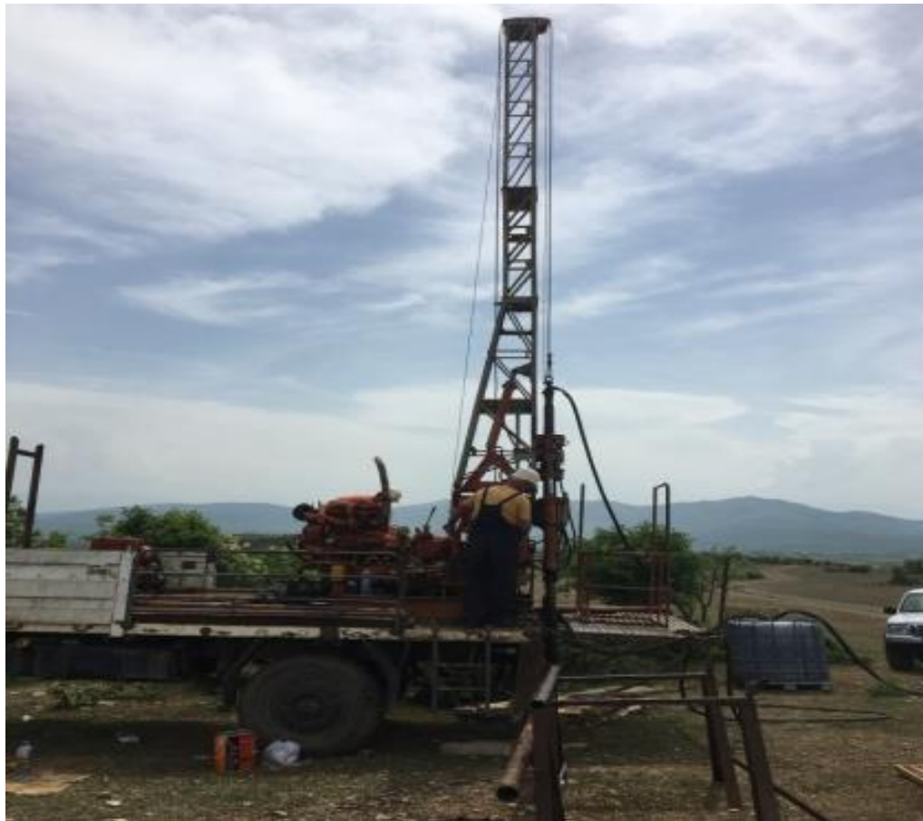
Figura 1 Mašina dubinskih bušenja -NKRM
