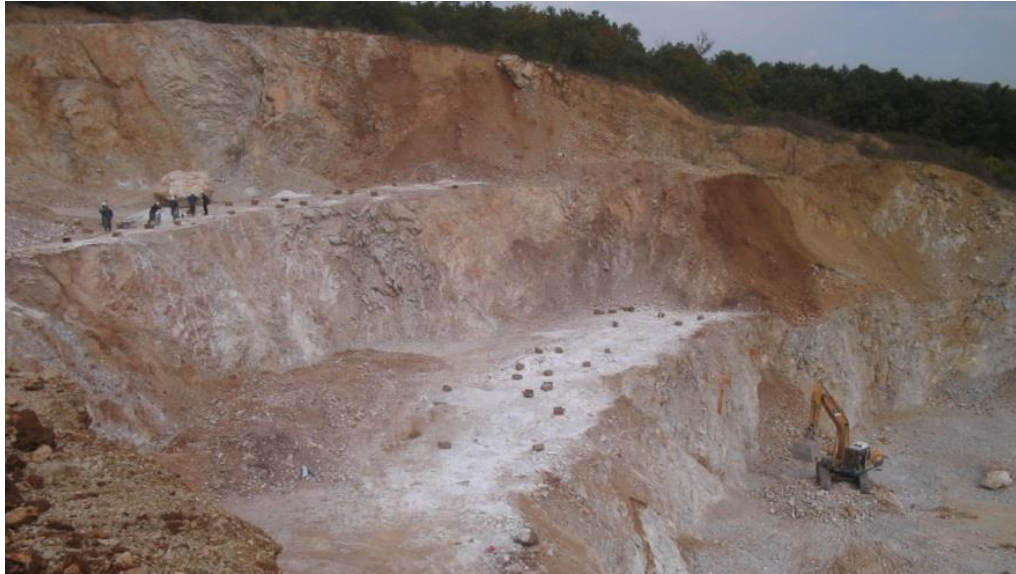
Figura 37 Priprema terena za rudarske aktivnosti za miniranje - MSPP
