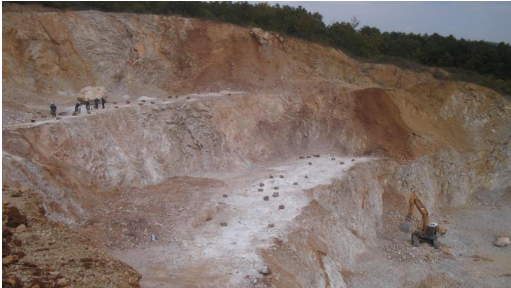
Figura 14 Rudarska aktivnost priprema oblasti za miniranje - NKRM
