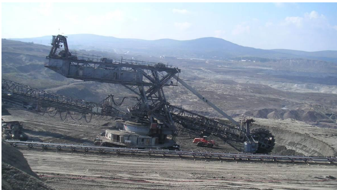
Figura 44. Eskavatori rotorik gjatë punës në minierën e KEK-ut
