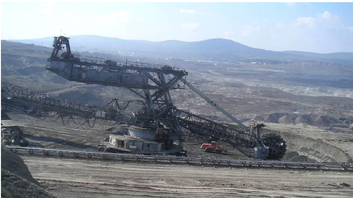
Figura 34. Eskavatori rotorik gjatë punës në minierën e KEK-ut
