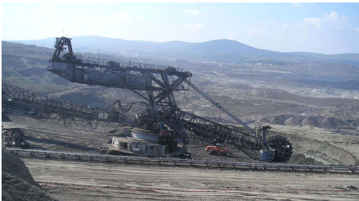
Figura 5. Foto – Eskavatori i mihjes në KEK
